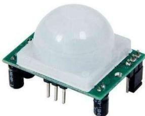
紅外線感測器 紅外線動作感測器(PIR Motion Sensor)或稱人體紅外線感測器，是一種可以偵測物體移動的電子裝置。紅外線動作感測器的原理，便是利用人體發射出來的紅外線的變化，來感應物體的移動(來源:維基百科)
