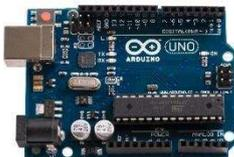
**ARDUINO** Arduino 包括一個硬體平台——**Arduino Board**，和一個開發工具——**Arduino IDE**
